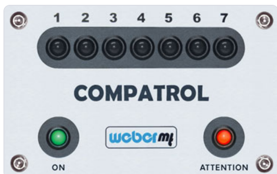
COMPATROL®-CCD sygnalizuje błąd: „grunt nie posiada nośności, podłoże nie nadaje się do zagęszczenia”.
