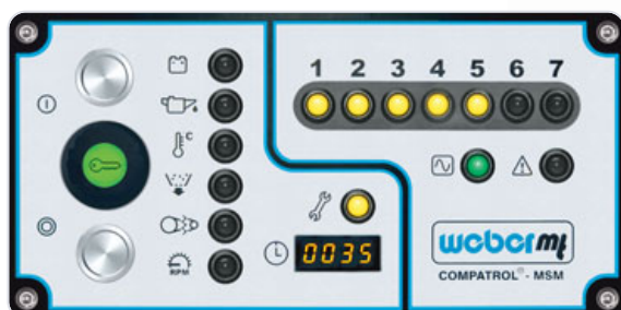
COMPATROL®-MSM sygnalizuje: należy wykonać przegląd.
